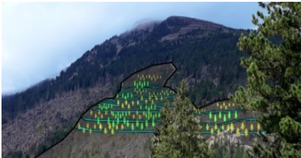
Fig. 9.13 Esempio di schema di rimboschimento per collettivo. In verde Larix decidua , in giallo gruppi di Pinus cembra . In azzurro sono evidenziate le linee di realizzazione per le opere paravalanghe.
